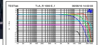
D/A-Wandler extrem breitbandig, Amp ausgewogen, nur an 2 Ohm Last etwas früher Höhenabfall
