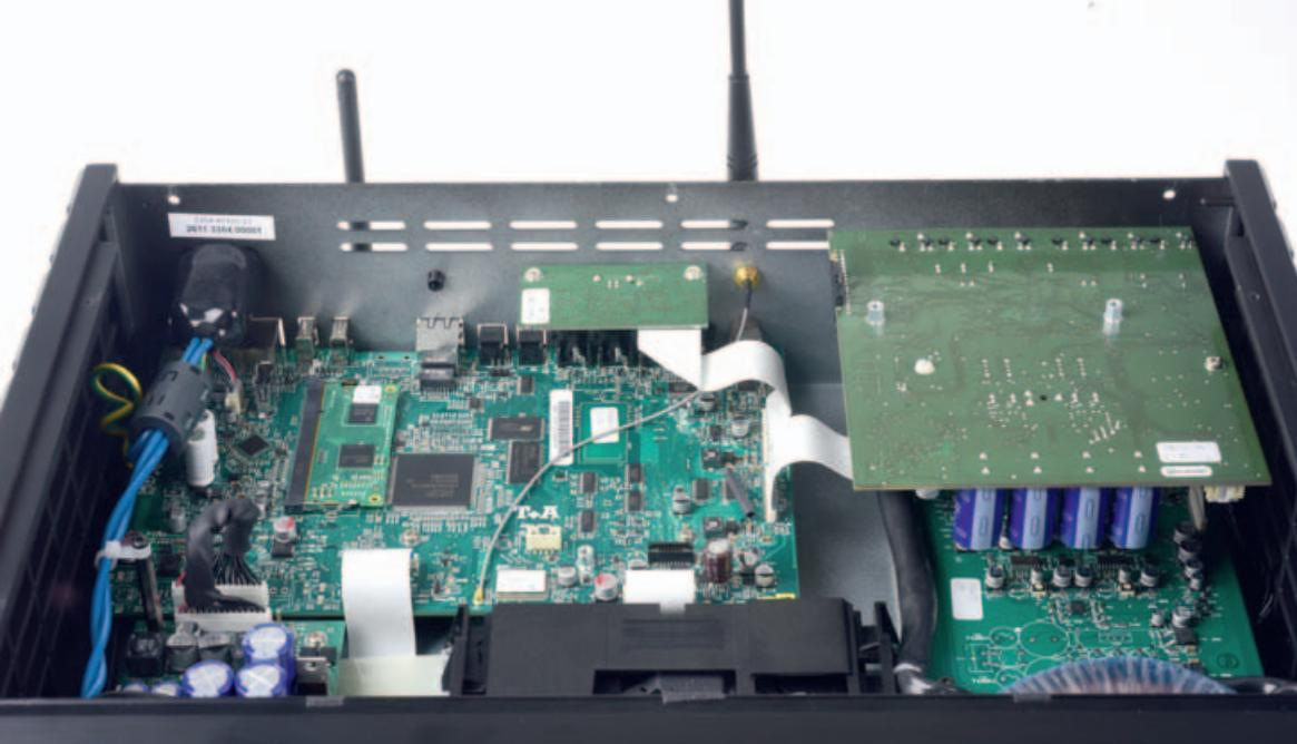
Rechts im Gehäuse der D-Endstufentrakt, der von einem konventionellen Netzteil versorgt wird. Der Vorverstärkertrakt bietet Funktionen wie etwa anpassbare Loudness und menügesteuerte Filter für den Betrieb mit Sub/Sat-Lautsprecherkombis. Ein Phono-MM- oder -MC-Modul ist nachrüstbar.
