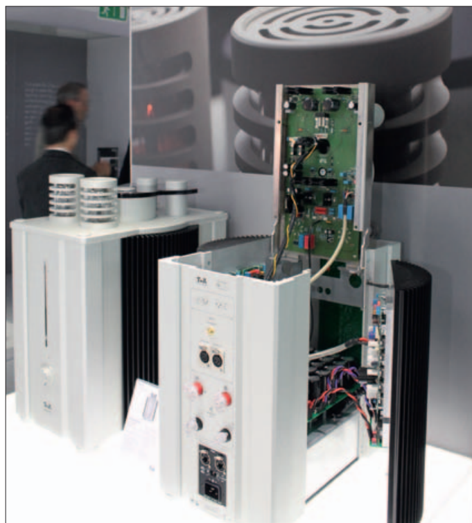
Auf der HIGH END 2018 in München zeigte T+A die Bauweise der M 40 HV anhand eines „aufgeklappten“ Exemplars.
