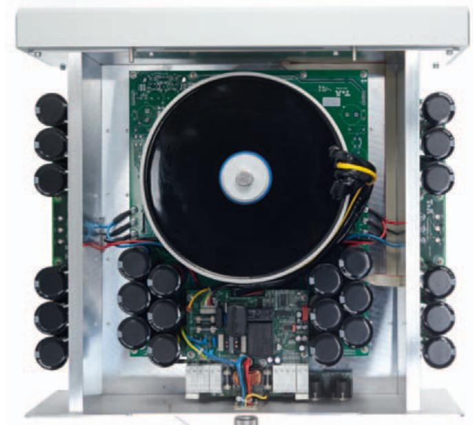
Mit seinem 1200 VA starken Ringkerntrafo und 240.000 Mikrofarad Siebkapazität fällt das PS 3000 nochmals deutlich kräftiger aus als die ohnehin schon üppig bestückte Endstufe A 3000.
