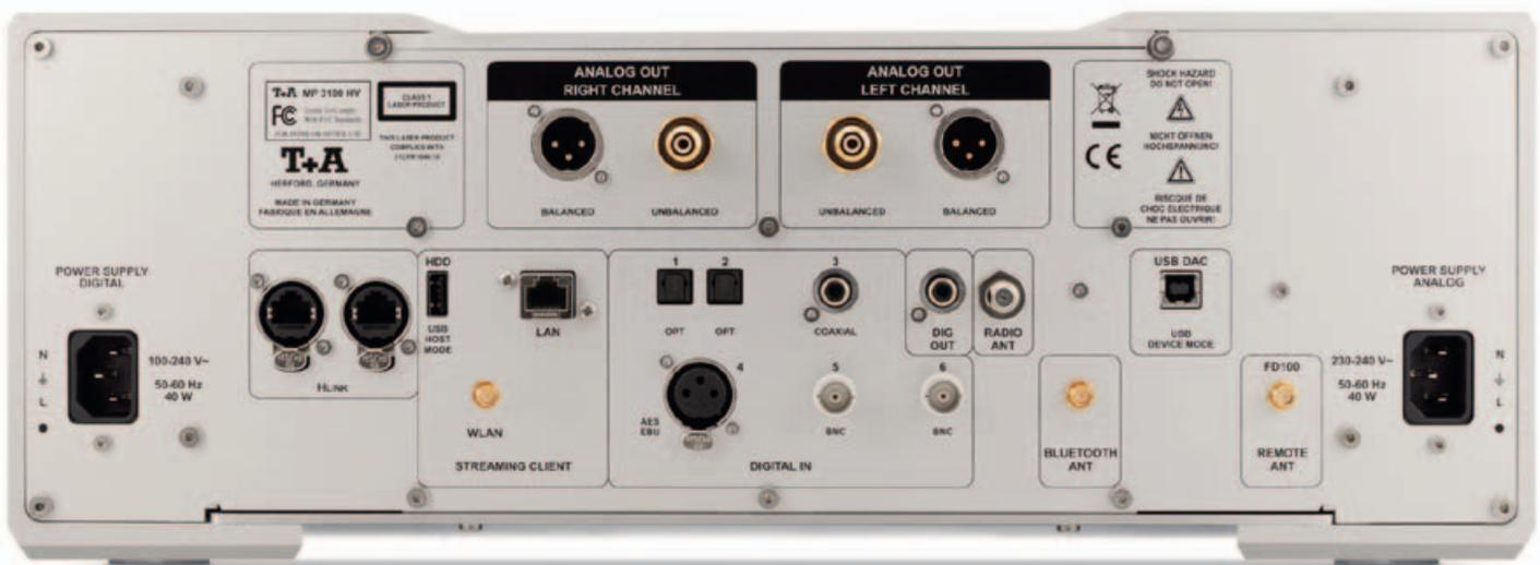
Gleich vier Antennenanschlüsse? Ja: für WLAN, Bluetooth, FM-Tuner und Funkfernbedienung. Die beiden Netzbuchsen links und rechts am Gehäuserand dienen den getrennten Analog- und Digitalnetzteilen. Eine weitere USB-Buchse befindet sich praktischerweise auf der Frontplatte. Eine eventuell angeschlossene Festplatte ist via Input-Menü einfach anwählbar, aber auf PCM-Musikmaterial beschränkt.
