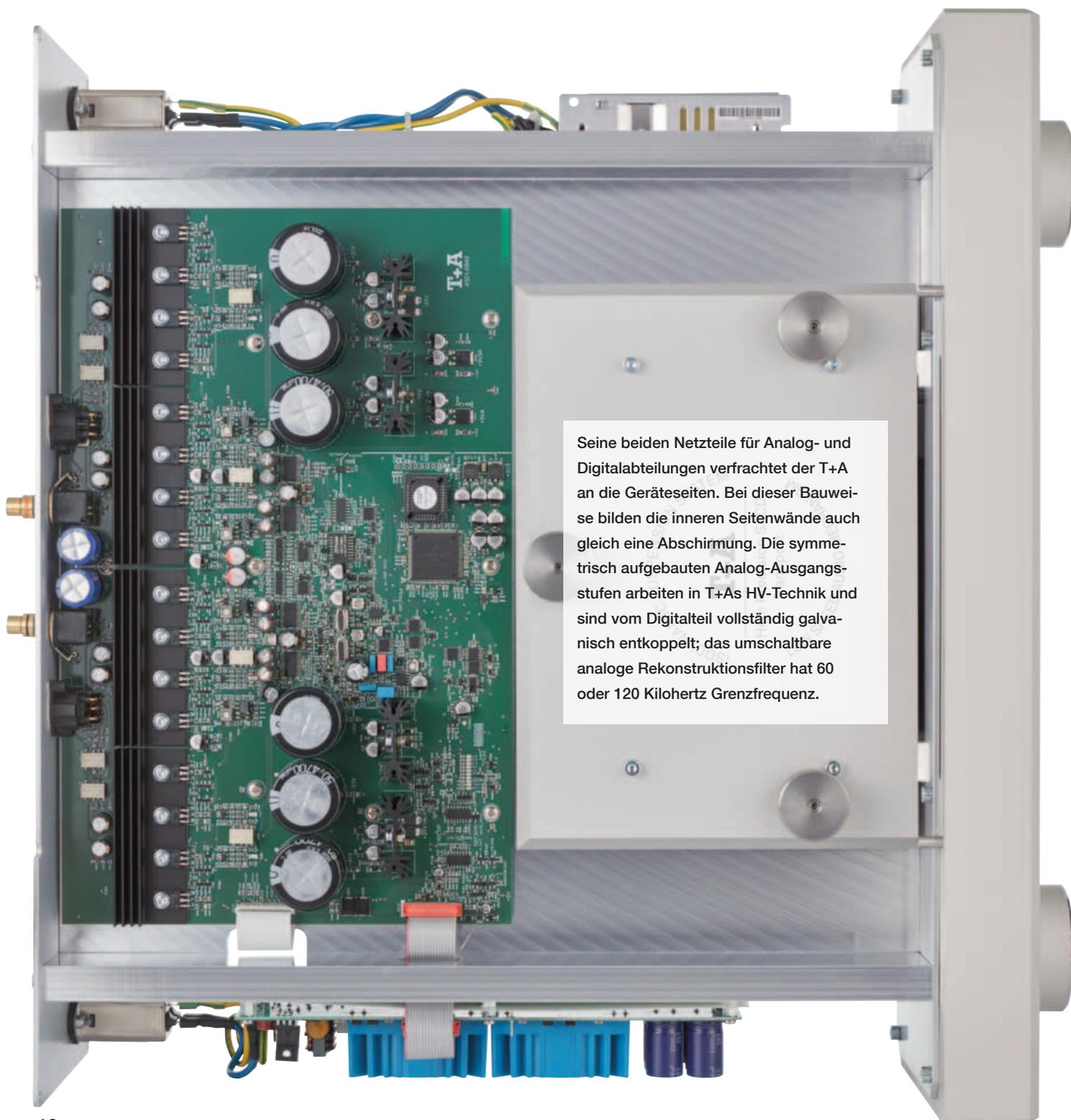
Seine beiden Netzteile für Analog- und Digitalabteilungen verfrachtet der T+A an die Geräteseiten. Bei dieser Bauweise bilden die inneren Seitenwände auch gleich eine Abschirmung. Die symmetrisch aufgebauten Analog-Ausgangsstufen arbeiten in T+As HV-Technik und sind vom Digitalteil vollständig galvanisch entkoppelt; das umschaltbare analoge Rekonstruktionsfilter hat 60 oder 120 Kilohertz Grenzfrequenz.
