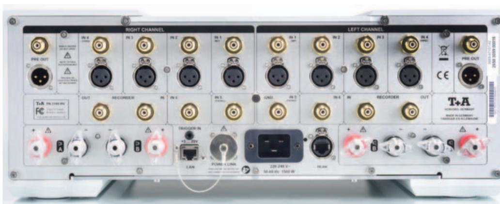
Optional ist der Einbau von MM- oder MC-Phonostufen sowie eines analogen Signal-Processor-Moduls zur kanalgetrennten Klangregel- und Loudness-Funktion möglich. Auch am Anschlussfeld sieht man unschwer den absolut kanalgetrennten, spiegelsymmetrischen inneren Aufbau des Vollverstärkers.
