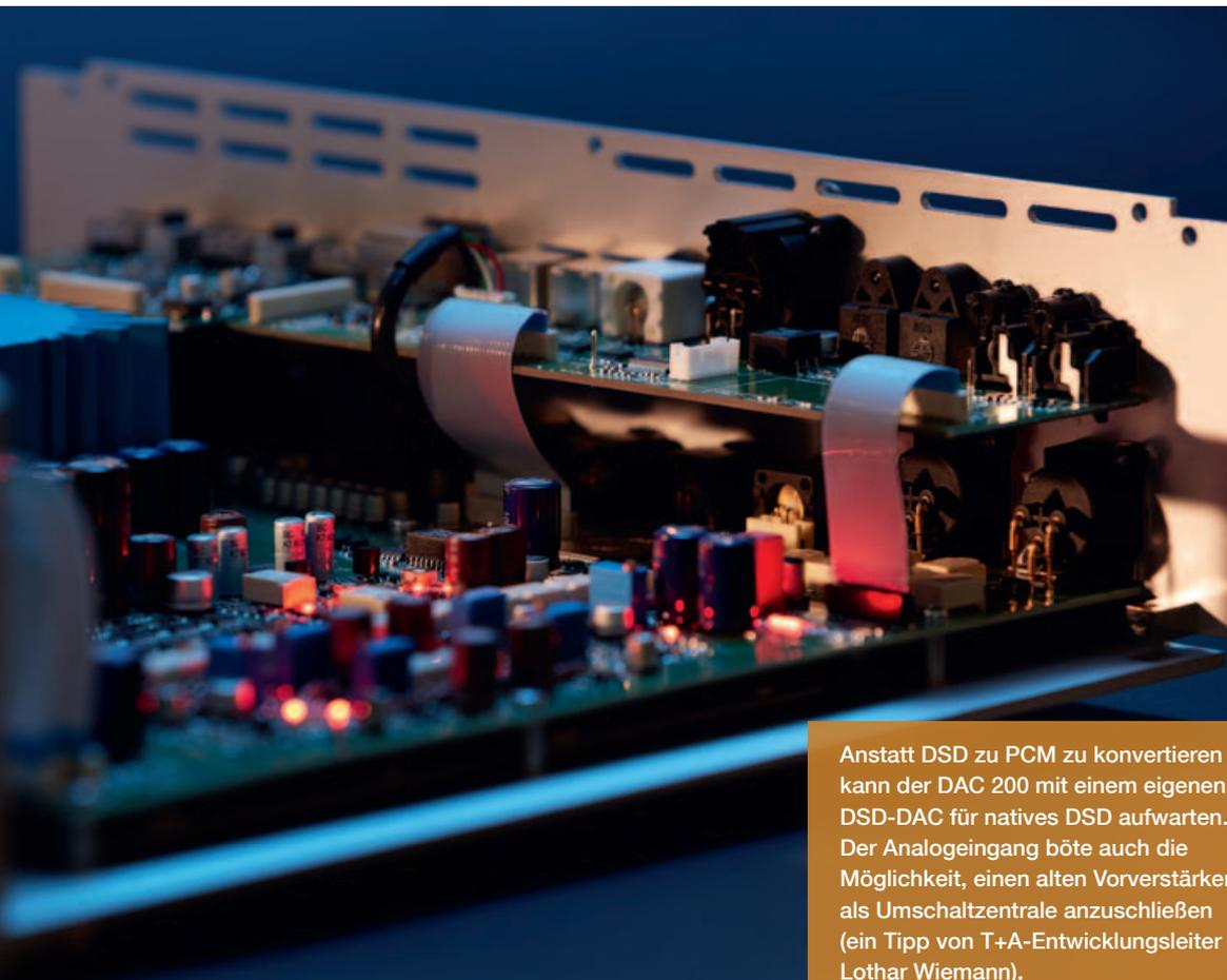
Anstatt DSD zu PCM zu konvertieren kann der DAC 200 mit einem eigenen DSD-DAC für natives DSD aufwerten. Der Analogeingang böte auch die Möglichkeit, einen alten Vorverstärker als Umschaltzentrale anzuschließen (ein Tipp von T+A-Entwicklungsleiter Lothar Wiemann).
