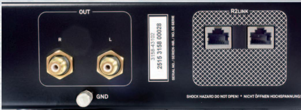
Plattenspieler mit Internet-Anschluss? Nein, so weit sind wir noch nicht. „R2Link“ dient der Vernetzung der R-Serie untereinander. Damit ist auch der G 2000 R fernschaltbar. Wahlweise baut T+A das Laufwerk auch mit integriertem Phonoverstärker, ein hochwertiges Anschlusskabel liegt ebenfalls bei.
