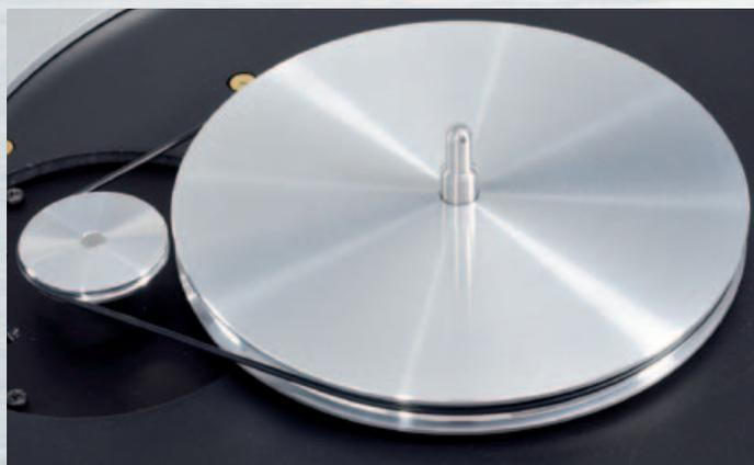
Auf fünf Mikrometer genau gefertigt, nach dem Einpressen des Achsdorns nochmals überarbeitet: Der Subteller besitzt eine Vertiefung für den präzisionsgeschliffenen Antriebsriemen.
