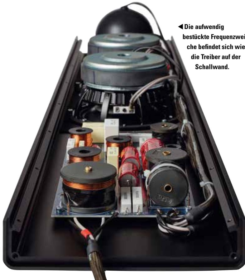
◀ Die aufwendig bestückte Frequenzweiche befindet sich wie die Treiber auf der Schallwand.
