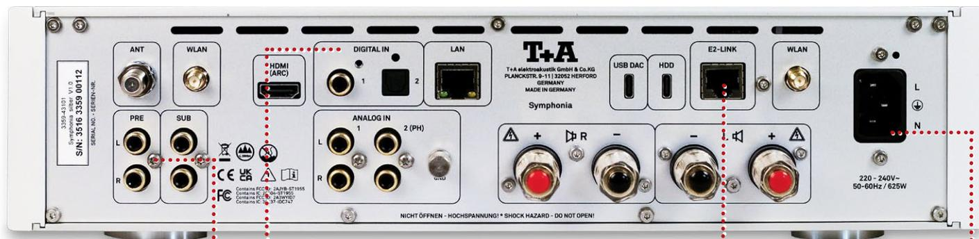
**Vorstufenausgänge:** Der Symphonia verfügt über Pre-Outs, um Aktivlautsprecher oder Endstufen anzuschließen. Auch Subwoofer können genutzt werden.
