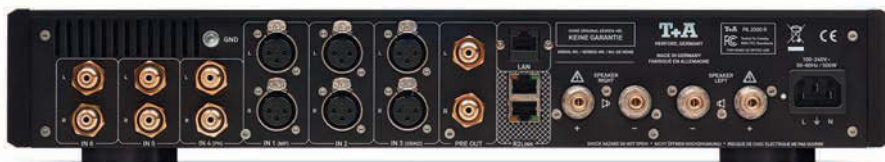
Der Verstärker bietet jeweils drei symmetrische und drei Cinch-Eingänge, Pre Outs und Anschlüsse für ein Boxenpaar. Ein Hochpegelanschluss kann (optional) zum Plattenspieleranschluss umgerüstet werden.
