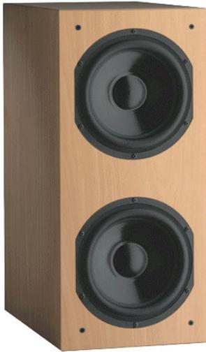
Zwei 22-cm-Magnesiumguss-Tieftöner erzeugen einen äußerst sauberen, druckvollen und tiefen Bass. Diese Tieftöner werden durch eine Aktiveinheit angetrieben. Um diesen Subwoofer optimal an ihren Raum und vorhandene Satelittenlautsprecher anzupassen, stehen eine stufenlos regelbare aktive Frequenzweiche, hochpassgefilterte Satellitenausgänge und eine Leistung von 125 Watt an 4 Ohm zur Verfügung.
