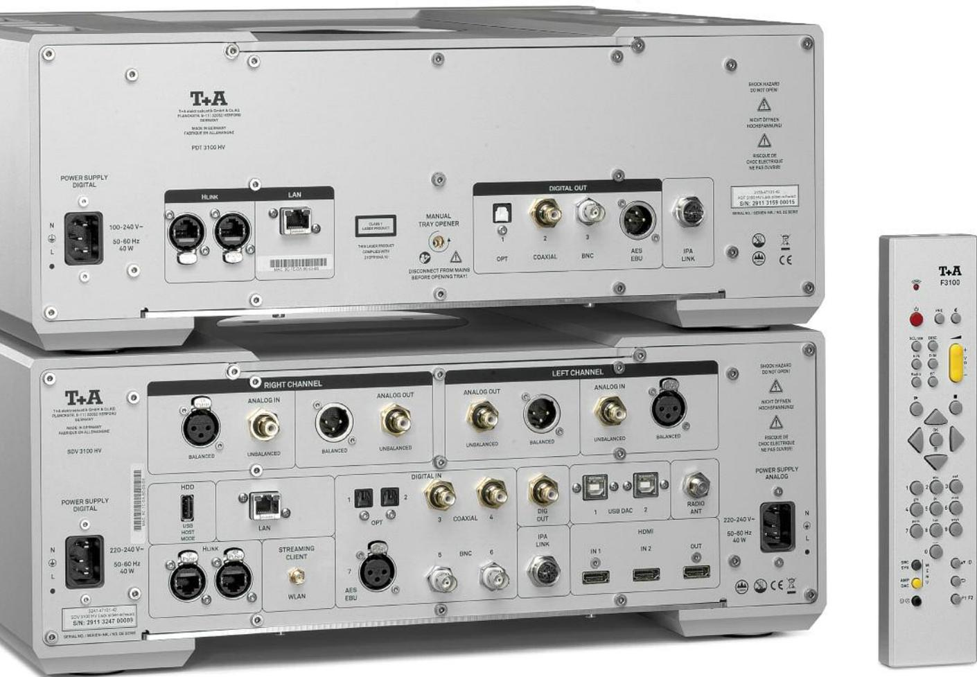
Alle Anschlüsse für die digitale Welt bietet der Referenz Streaming DAC Vorverstärker (Gerät unten). Oben sind die analogen Ein- und Ausgänge zu sehen. Links in der Mitte docken USB, LAN und WLAN an. In der Mitte befindet sich das Feld mit den üblichen Digitaleingängen von TOSLINK über AES/EBU bis zu Coax und BNC. Rechts daneben befinden sich der haus eigene IPA Link, die USB DAC-Buchsen für den Anschluss von Laptop oder PC, der Anschluss für eine FM-Antenne und darunter drei HDMI-Eingänge
