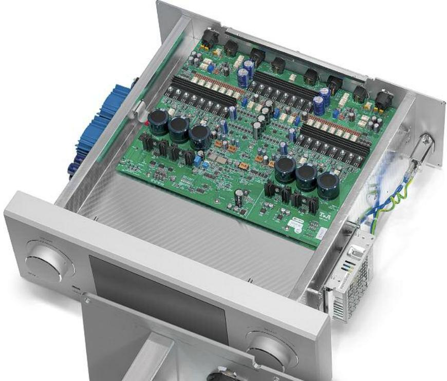
Auf der Oberseite des SDV 3100 HV befindet sich die Platine für die analogen Schaltungen und die D/A-Wandler. In der Mitte hinten ist die analoge Lautstärkeregelung zu sehen, bei der ein Widerstandsnetzwerk über Relais geschaltet wird. Alle analogen Stufen arbeiten in Class A und mit der High Voltage Technik von T+A
