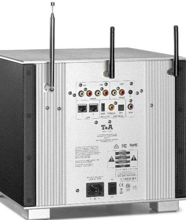
Für jeden etwas dabei: Ein Trio aus Antennen für Bluetooth-, WLAN- und Rundfunkempfang wird ergänzt durch zwei analoge Hochpegeleingänge, drei Digitaleingänge und einen durchgeschleiften Netzwerkanschluss. Wer mag, kann separat einen Subwoofer, eine andere Endstufe oder auch einen Kopfhörer ankabeln
