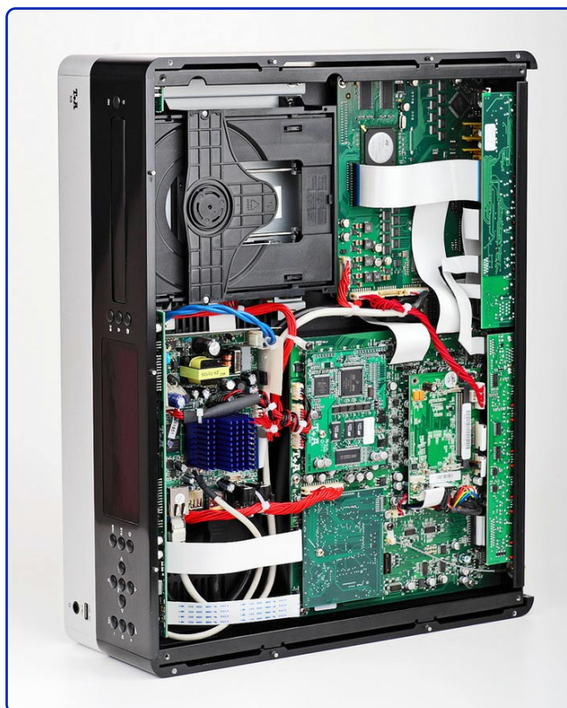
Hohe Packungsdichte kennzeichnet das Innere des T+A Blu-ray Receivers K8.
