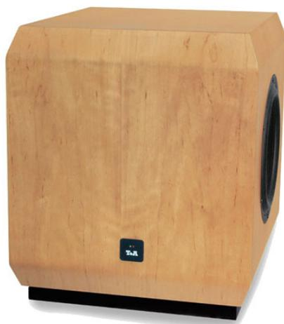
Der **TCI W2** ist unser aktiver Subwoofer mit 2 260 mm Spezialtiefsttonchassis für den Einsatz in Subwoofern. Der extrem stabile Magnesium-Druckgusskorb trägt einen riesigen Antriebsmagneten, der für den guten Wirkungsgrad auch bei tiefsten Frequenzen sorgt. Die Membran ist aus 3 mm dickem Aluminium hergestellt und damit auch bei größten Auslenkungen und Beschleunigungen völlig verwindungsfrei.
