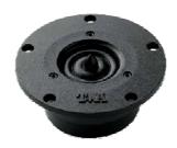
Wie in der TCI 3R verwenden wir unseren <u>Super Hochton Ringstrahler</u>. Eine geniale Konstruktion, bei der eine ringförmige Membran zentral von einer 30-mm-Schwingspule angetrieben wird. Deshalb entkoppelt die Membran weder bei hohen Frequenzen, noch bei hohen Amplituden. Die Eigenresonanz dieses einmaligen Hochtöners liegt bei 500 Hz und die obere Grenzfrequenz bei 50000 Hz. Damit erreicht er einen unglaublich großen Übertragungsbereich mit geringstem Klirrfaktor und bester Linearität.
