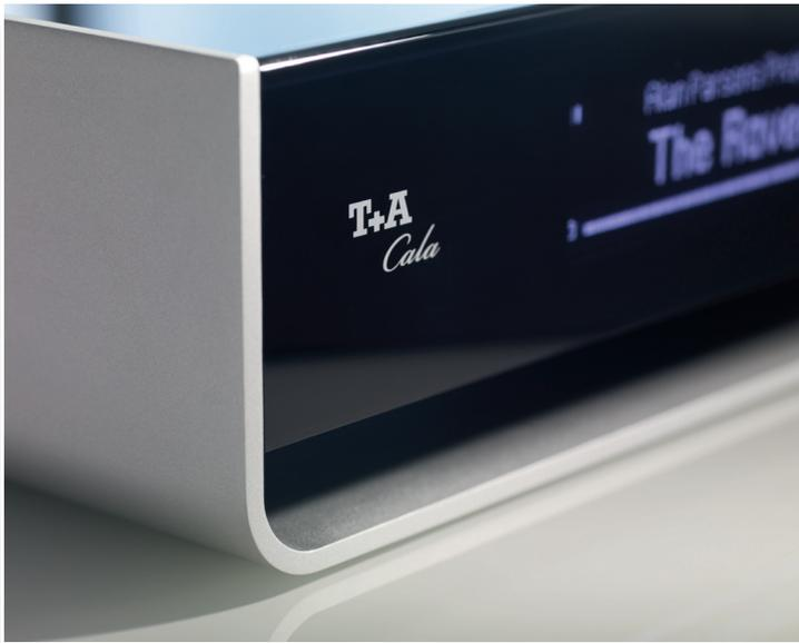
Der Korpus besteht aus massivem Aluminium und wird mit Hilfe eines komplexen Werkzeugs in einem Arbeitsgang im Strangpressverfahren hergestellt, anschließend mit Glasperlen feingestrahlt und eloxiert. Das innere Chassis, das die gesamte Elektronik trägt, ist ebenfalls aus Aluminium gefertigt, die Front und der Deckel bestehen aus hochglänzendem Acryl.
