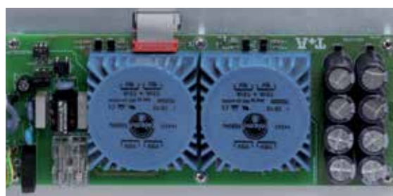
EL SUBSISTEMA DE ALIMENTACIÓN CORRESPONDIENTES A LOS CIRCUITOS ANALÓGICOS COMPRENDE DOS TRANSFORMADORES DE ALTAS PRESTACIONES MONTADOS EN UNA PLACA DE CIRCUITO IMPRESO DISPUESTA EN UNO DE LOS LATERALES DEL MP 3000 HV, UNA UBICACIÓN QUE GARANTIZA UN BLINDAJE MUY EFECTIVO FRENTE A POSIBLES INTERFERENCIAS.
