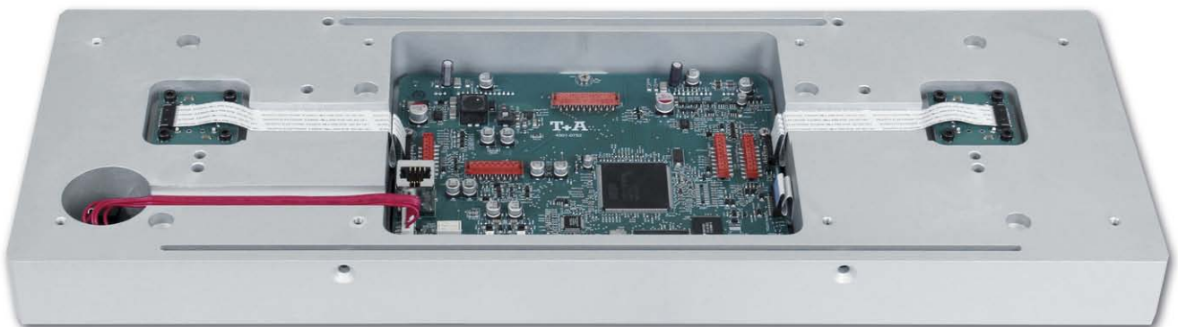
Die Gehäuse der HV-Serie sind mit Aluminium-Körpern in Sektionen aufgeteilt, auch die Display-Einheit hat eine eigene Abschirmung, hier zu sehen beim PA 3000 HV
