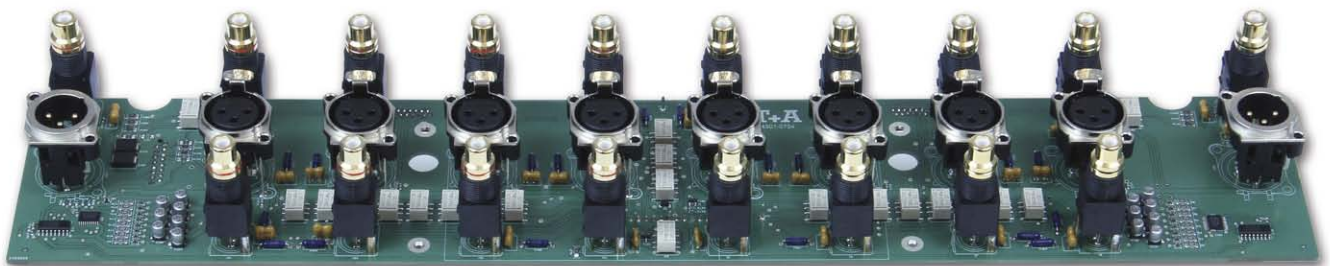
Zwei der symmetrischen XLR-Eingänge können asymmetrisch konfiguriert werden
