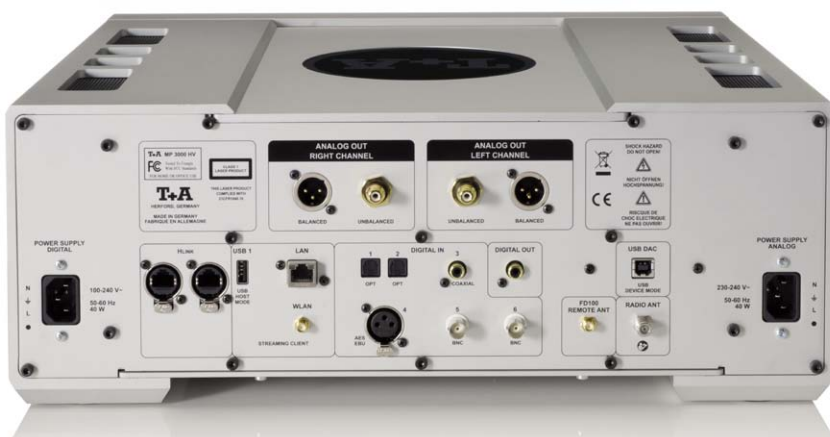
Der MP 3000 HV bietet zusätzlich zum frontseitigen USB-Eingang einen weiteren USB-Port für Massenspeicher und einen 192 kHz / 32 Bit-fähigen USB-Port
