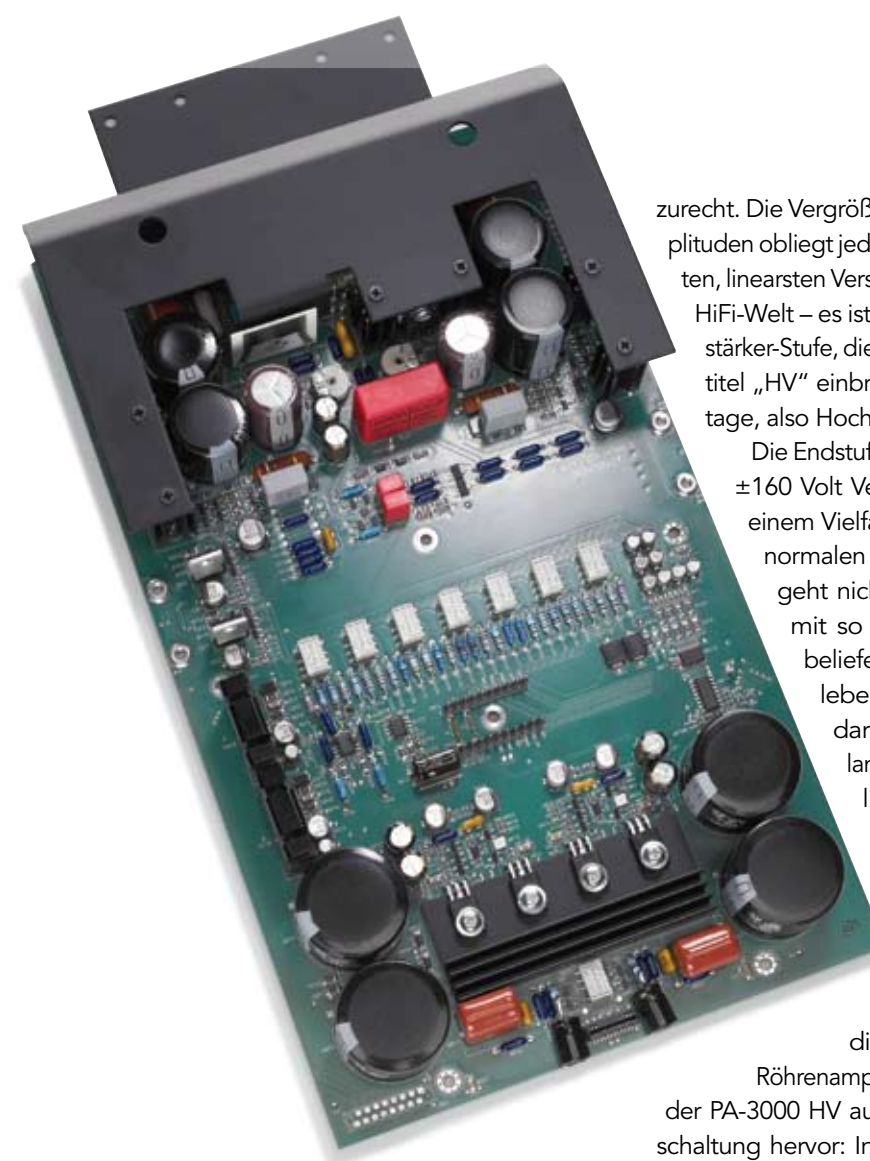
Klangzentrale: Eines der zwei Spannungsverstärker-Boards im PA-3000HV. In der Mitte die Lautstärke-Relais (weiß).
