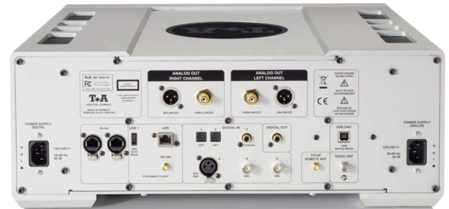
Ungewohnte Vielfalt: Neben den üblichen Ein- und Ausgängen hält der MP-3000HV Steuerbuchsen bereit, um andere T+A-Geräte in die App-Steuerung einzubeziehen und bietet Digital-Inputs im elektrisch korrekten BNC-Format.
