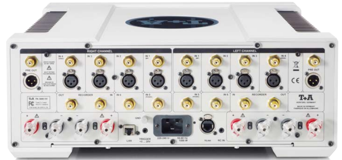
Großes Gedeck am Heck: Die Boxenklemmen haben rhodiumbeschichtete Kontaktflächen, die Langlebigkeit mit Leitfähigkeit optimal verbinden. Da der PA-3000HV in 110V-Ländern über 16 Ampère aus dem Netz zieht, ist die 20A-Stromanschlussbuchse dort vorgeschrieben (Mitte) – T+A verwendet sie der Einfachheit halber aber auch für die Inlands-Versionen.
