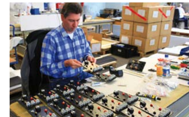
Solitaire-Terminale: Feinste Schalter und Buchsen werden von Hand montiert.
