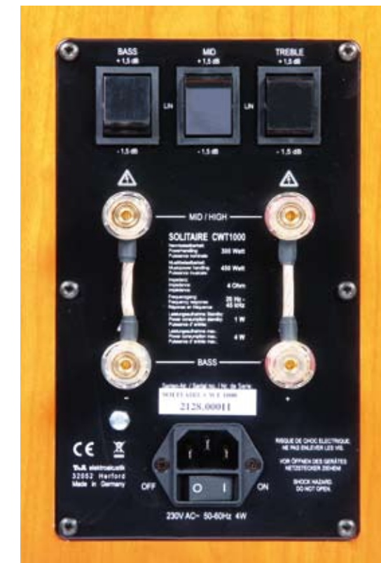
Das Anschlussfeld: oben die Anpassung der Box an die Raumakustik. Die Schalter wirken bloß subtil (Mitten) oder schmalbandig (Bässe und Höhen). Die Anschlüsse sind konsequent für Bi-Amping ausgelegt. Die Netzstromversorgung dient nur der Vorspannung des Elektrostaten.
