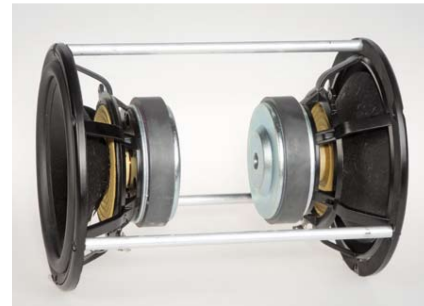
Verbindung: Je zwei Bässe sind über Stangen verschraubt und schwingen entgegengesetzt. Körperschall löscht sich damit fast komplett aus.
