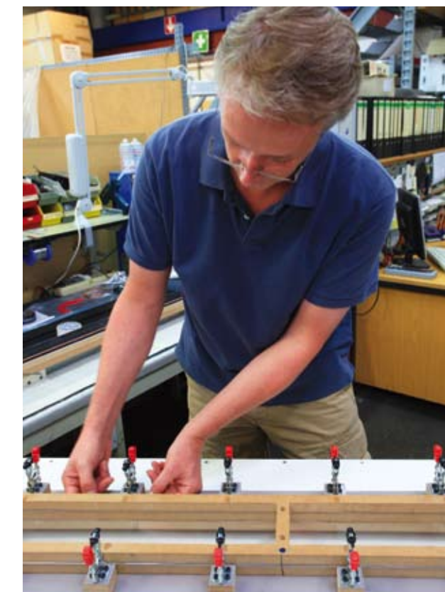
Ein spezielles Werkzeug hilft beim exakten Aufziehen der Elektrostaten-Folie auf den Rahmen.
