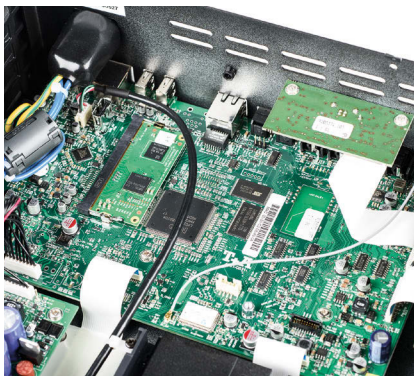
Płyta główna części cyfrowej to własne opracowanie T+A. Nie znajdziemy tu żadnych „gotowców” OEM.
