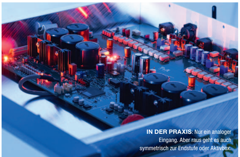
DUAL-MONO-AUF-BAU: Der ist deutlich auf der großen Analog- und Wandlerplatine erkennbar. Das gilt auch für die Relais-Phalanx der feinstufigen Pegelsteller.
