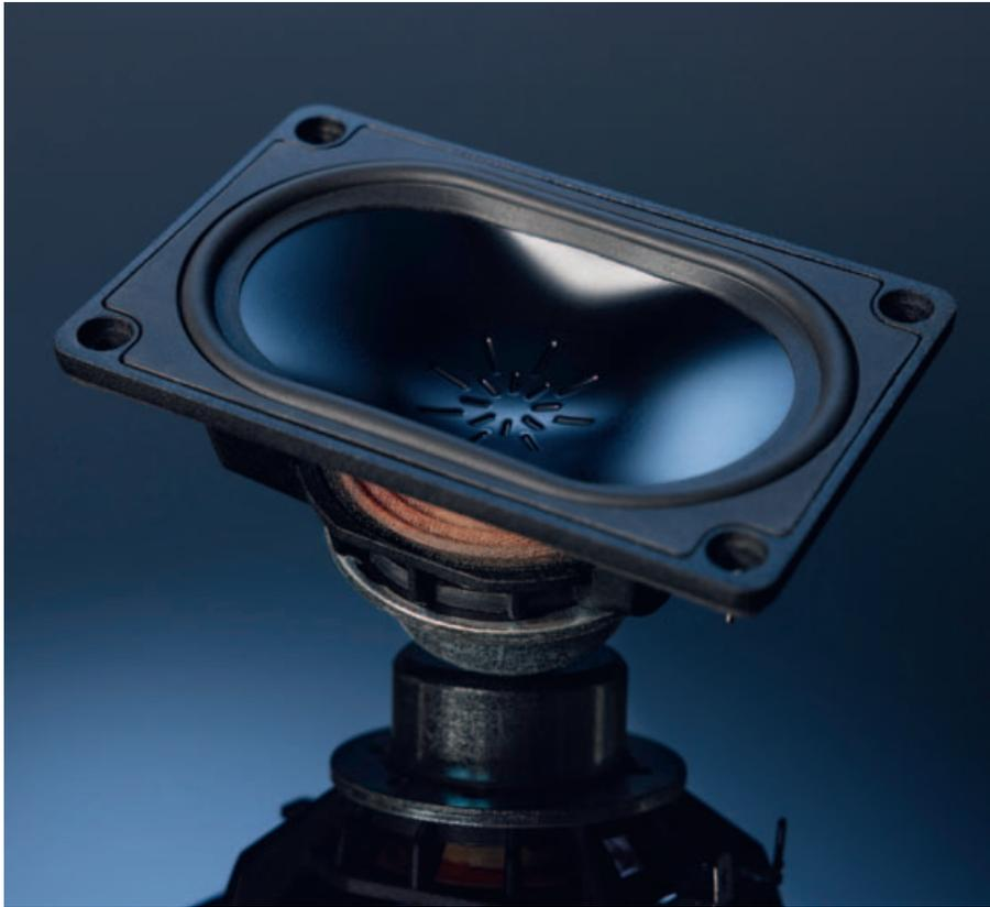
**SCHLANKE ERSCHEINUNG:** Die längliche, schmale Membran des Mitteltöners ermöglicht den Aufbau einer hohen Lautsprecherzeile mit breitem horizontalem Abstrahlverhalten.
