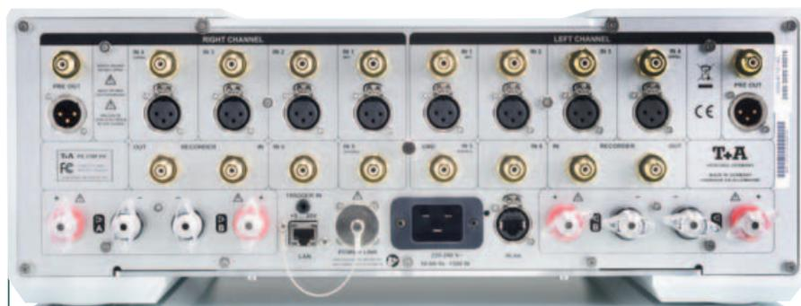
**TRENNEN, WAS VERSTÄRKT WIRD:** Das achsensymmetrische Anschlussfeld trägt die penible Kanaltrennung des Innenlebens nach außen. Unten neben der LAN-Buchse für Software-Updates der gut verschlossene Zugang für die Zusatz-Stromversorgung.
