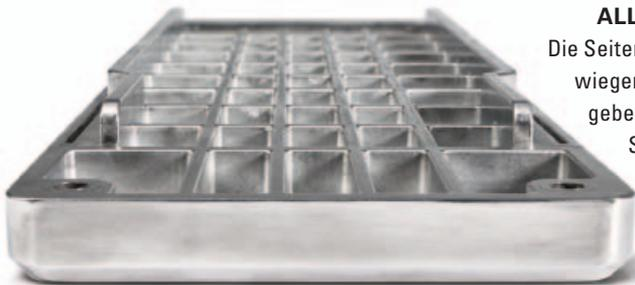
**ALLES, WAS HART MACHT:** Die Seitenwangen aus Zinkdruckguss wiegen 2 Kilogramm pro Stück und geben dem Gehäuse eine enorme Stabilität. Es gibt sie (wie die Front) schwarz oder silberfarben lackiert. Auch sie sind made in Germany – und das sehr präzise.
