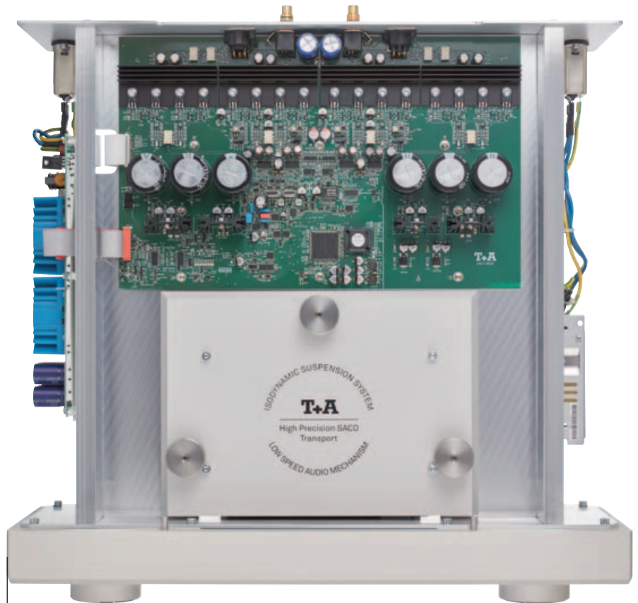
AUF DREI BEINEN: Das selbst entwickelte SACD/CD-Laufwerk ruht auf einem Dreipunkt-Subchassis. Das garantiert absolute Stabilität, denn es wirken keine Torsionskräfte. Getreu dem Motto: Nur ein Tisch mit drei Beinen kann nicht wackeln.
