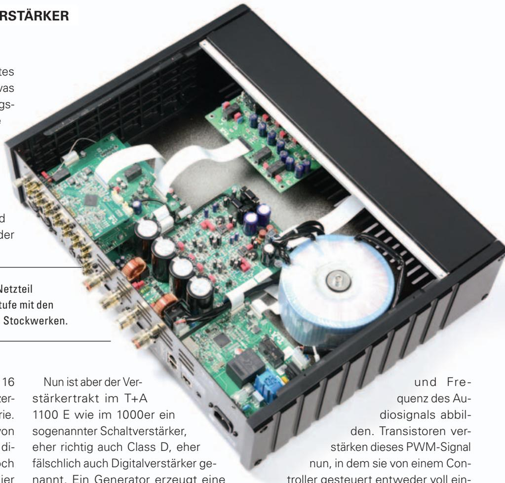
**INNEN:** Den rechten Teil dominiert das Linear-Netzteil mit dem Ringkerntrafo, die Mitte die Schaltendstufe mit den großen Spulen. Links die Eingänge auf mehreren Stockwerken.
