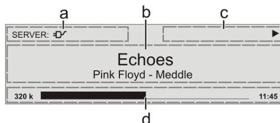
Die Anzeigen und Symbole des Displays hängen von der gerade aktiven Funktion ab.
