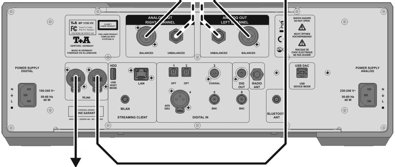
HLink Verbindung zum nächsten Gerät /
