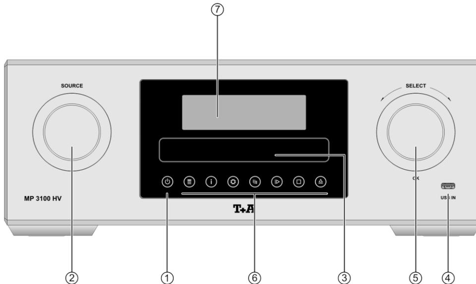
Mit den Tasten und Drehknöpfen an der Gerätefront können alle wichtigen Funktionen des **MP 3100 HV** bedient werden. Für die Quellenwahl und Navigation / Steuerung stehen die großen Drehknöpfe zur Verfügung. Seltener benötigte Funktionen werden über ein Menü bedient, welches über die ☰-Taste aufgerufen wird.
