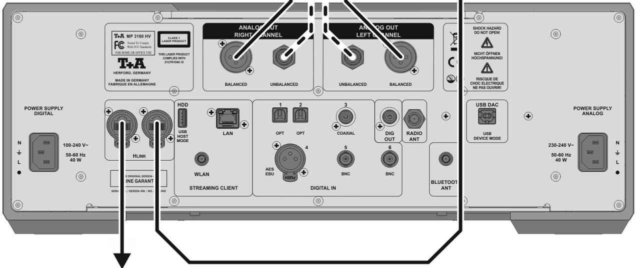
HLink Verbindung zum nächsten Gerät /
