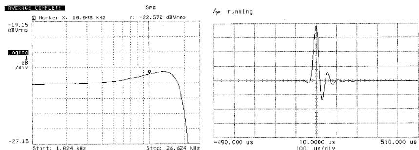
Frequenzgang und Einschwingverhalten des Bezier-Interpolators plus IIR-Filter
