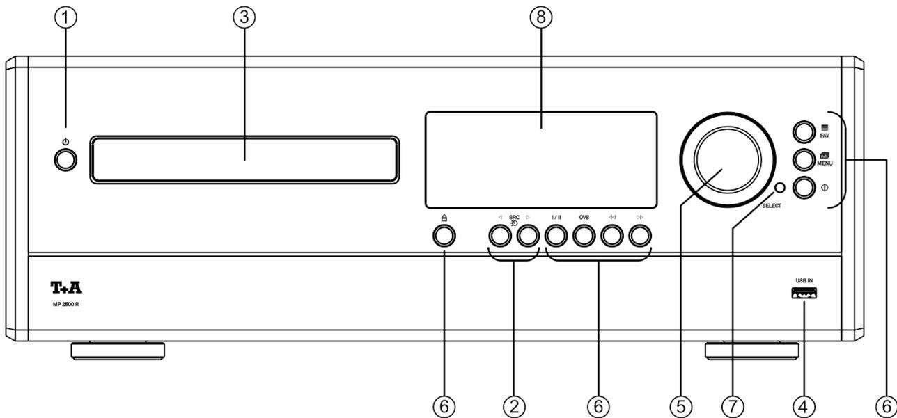
Mit den Tasten und dem Drehknopf an der Gerätefront können alle wichtigen Funktionen des **MP 2500 R** bedient werden. Für die grundlegenden Funktionen, wie z.B. die Quellenwahl, stehen direkte Bedientasten zur Verfügung. Seltener benötigte Funktionen werden über ein Menü bedient, welches über die **MENU**-Taste aufgerufen wird.
