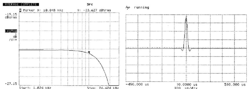
Frequenzgang und Einschwingverhalten des Bezier-Interpolators
