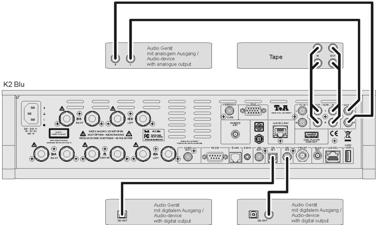
**Anschluss-Schema / Wiring diagram**
