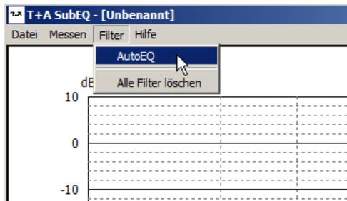
Nach kurzer Verzögerung erscheinen die berechneten Filter. Die AutoEQ Funktion filtert ausschließlich die Überhöhungen. Einbrüche werden nicht angehoben: an anderen Stellen im Raum sind dies häufig Überhöhungen, die dann nur umso stärker wären.
