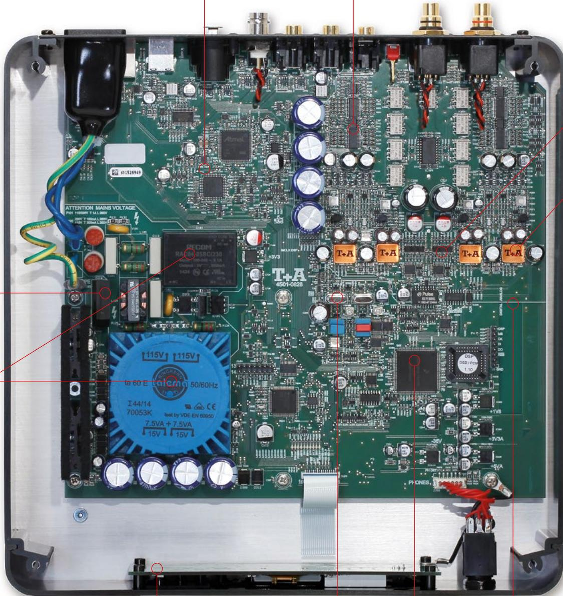
Getrennte Netzteile für Analog- und Digitalteil zur Verhinderung von Störeinflüssen auf die Audiosignale.
