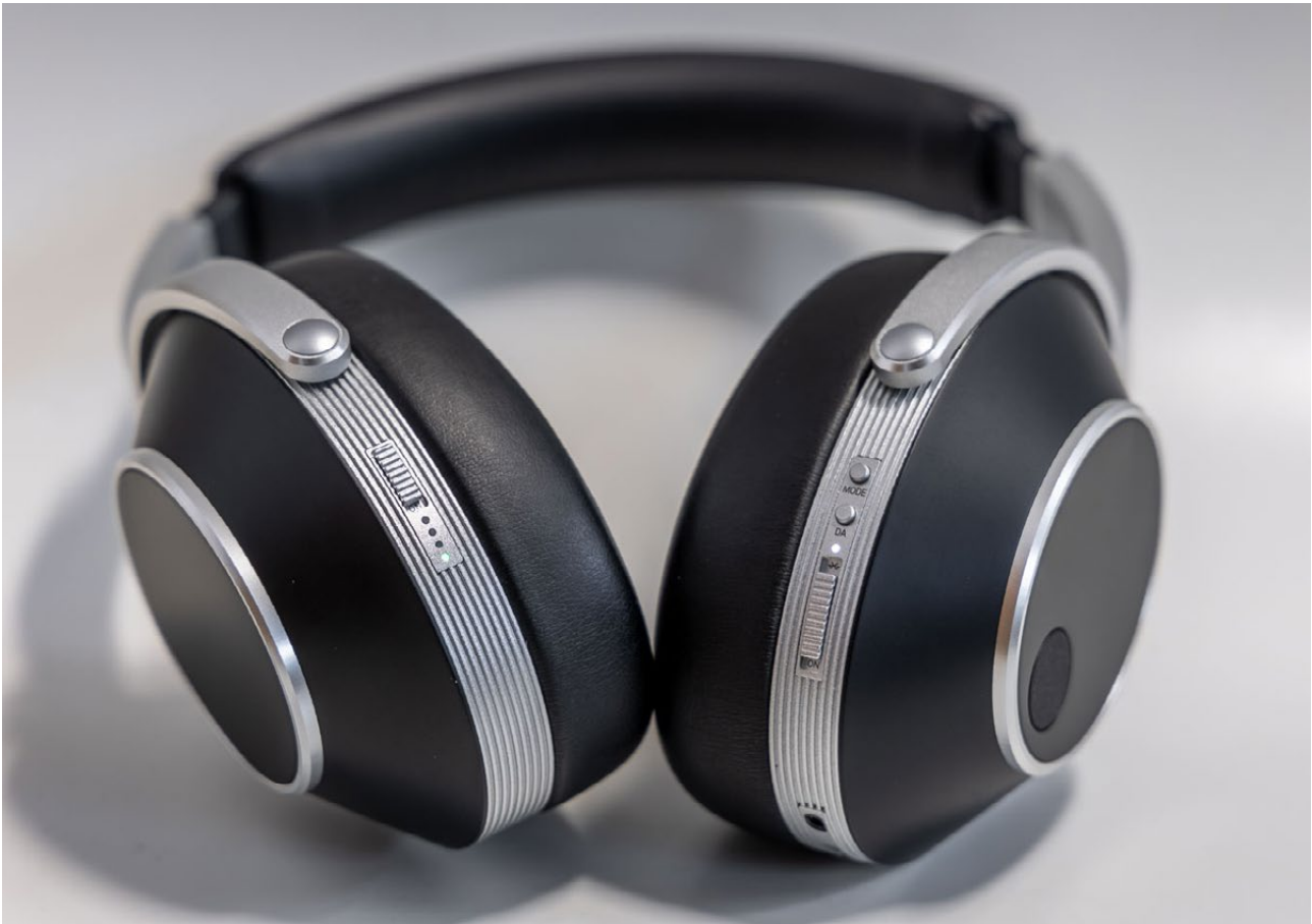
Links der Ein/Ausschalter und die Akku/Status-LEDs. Am rechten Hörer sind weitere Tasten und Bedienelemente
