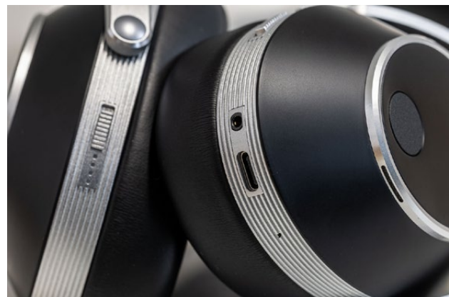
Am rechten Hörergehäuse sind der USB-C-Anschluss zum Laden und für Musikwiedergabe vom Mac/PC, sowie der analoge, symmetrische Klinkeneingang
