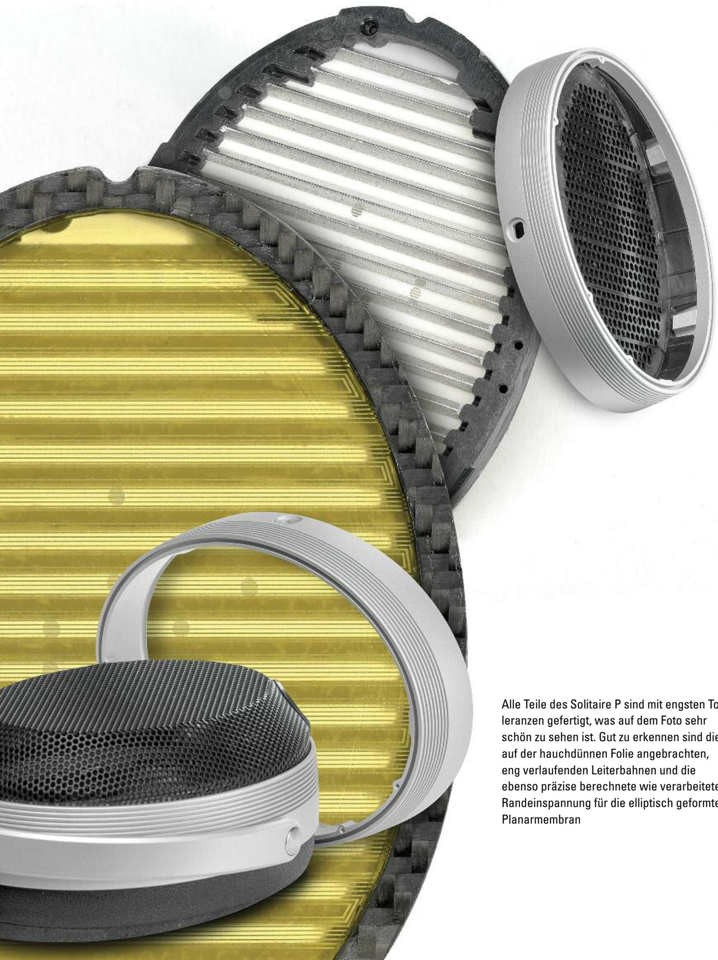
Alle Teile des Solitaire P sind mit engsten Toleranzen gefertigt, was auf dem Foto sehr schön zu sehen ist. Gut zu erkennen sind die auf der hauchdünnen Folie angebrachten, eng verlaufenden Leiterbahnen und die ebenso präzise berechnete wie verarbeitete Randeinspannung für die elliptisch geformte Planarmembran
