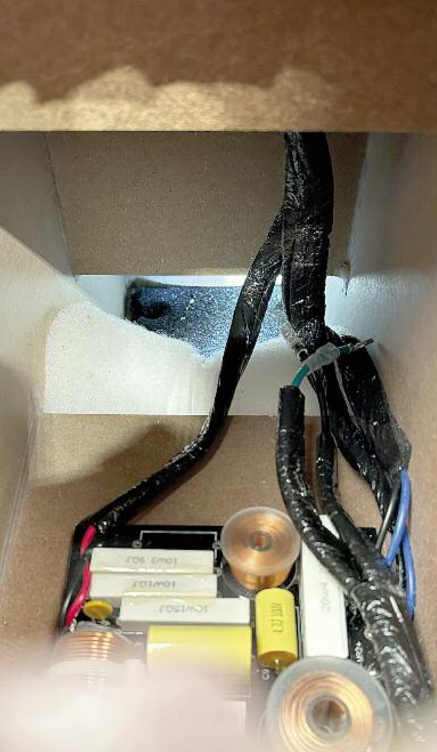
Oben: Aufgeteilte Signalverbindung für getrennte Zweige der FSR-Frequenzweiche
