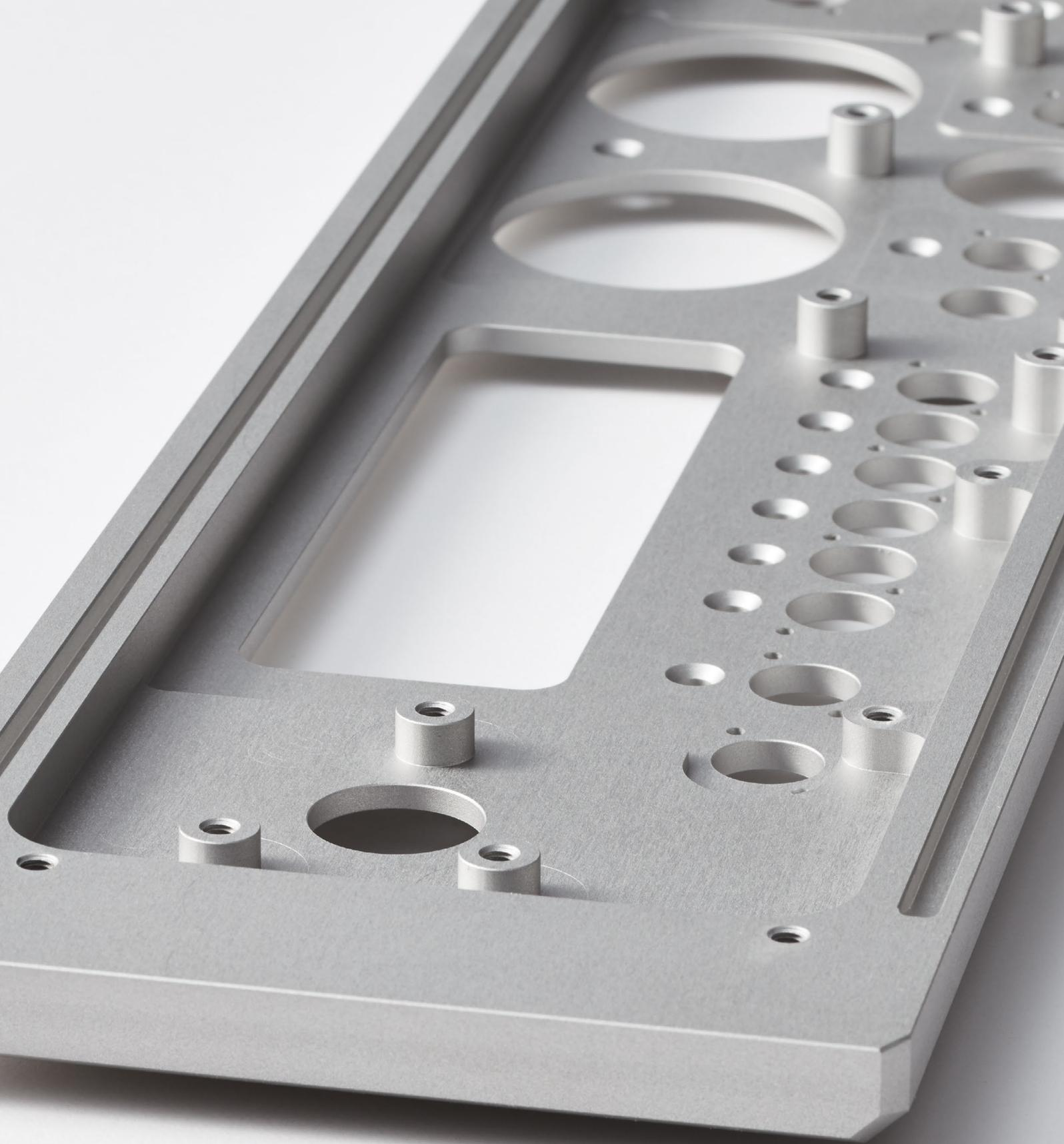
Wir haben den HA 200 auch für den professionellen Einsatz vorgesehen, deshalb ist das Gehäuse besonders robust und massiv konstruiert. Die Kühlkörper werden mit einem Strangpressprofile hergestellt, die Front aus dem Vollen gefräst, Deckel, Boden und Rückwand sind aus Aluminiumplatten gefertigt. Hohe Passgenauigkeit und engste Toleranzen zeichnen dieses Gehäuse aus.
