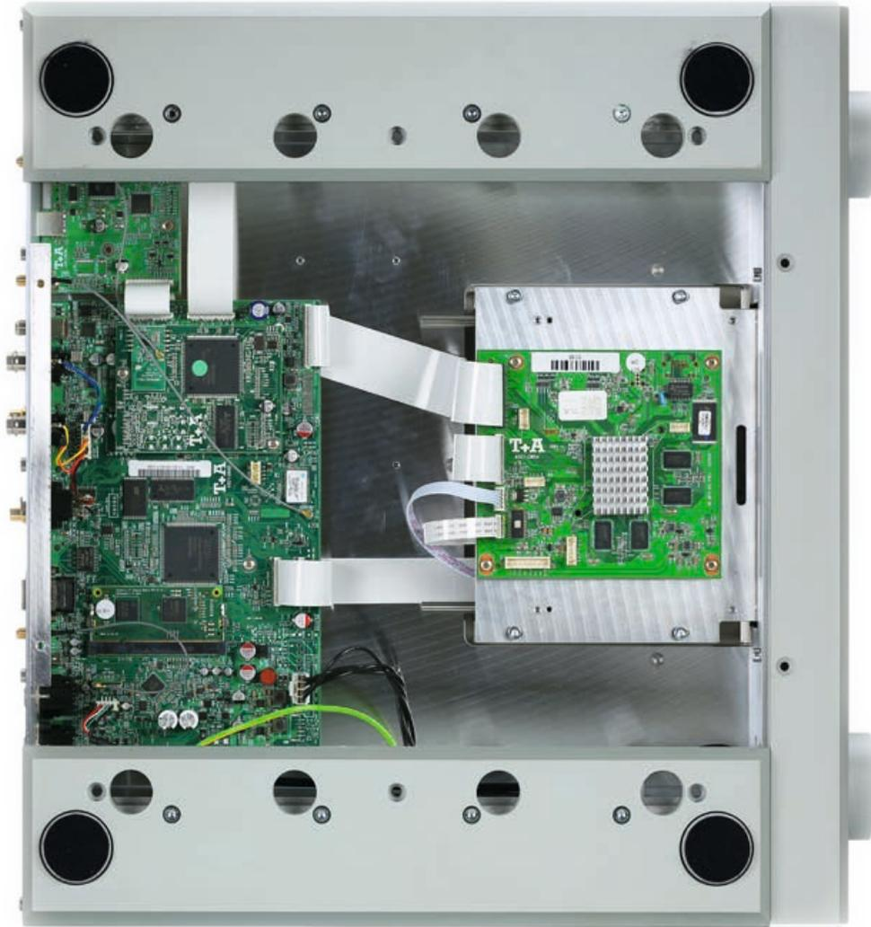
Da der MP 3100 HV ein Digitalgerät ist, verdient die Signalverarbeitung à la T+A eine eingehendere Betrachtung. Um bestmögliche Wandlungsergebnisse zu erreichen, wird die Verarbeitung von DSD und PCM von separaten Wandlern mit eigenen, vollständig voneinander getrennten Signalwegen erledigt. Die konsequente galvanische Trennung zwischen Analog- und Digitalteil eliminiert nach Auskunft von Chefentwickler
