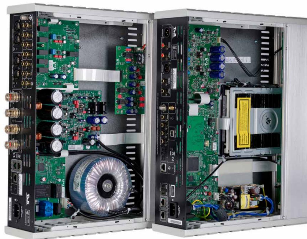
Strikte Aufgabenteilung: Der Vollverstärker (links) ist abgesehen vom Fernbedienungs-Controller strikt analog aufgebaut, alles Digitale steckt derweil im D/A-Wandler und Streamer des Multiplayers (rechts).
