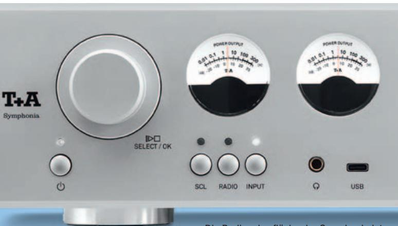
Die Bedienoberfläche der Symphonia ist geteilt: Links befinden sich die Tasten für die drei Quellengruppen SCL, Radio sowie Input und ein Dreh-Drück-Steller für die Menüsteuerung.
