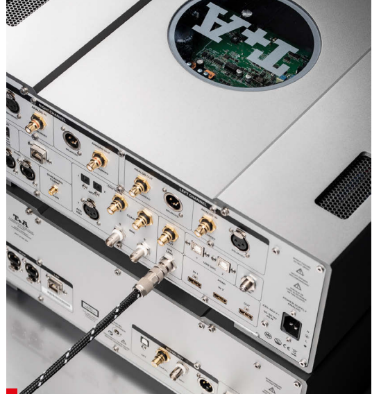
IPA Link, czyli autorski interfejs cyfrowy T+A usuwa ograniczenia standardowego łącza S/PDIF.
