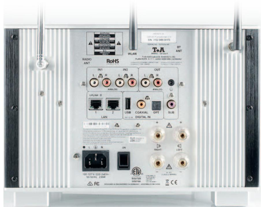
**FEST ODER IN WELLEN:** Der Caruso Receiver nimmt die Daten wahlweise per Ethernet, Cinch oder USB entgegen. Dazu gibt es Antennen für WLAN, Bluetooth, UKW und DAB+.
