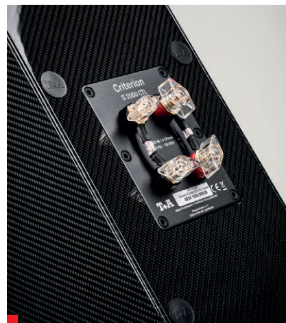
Okrągłe zaślepki skrywają długie pręty przechodzące przez całą głębokość obudowy. Tylna ścianka jest wklejona w korpus. Podwójne terminale wykorzystują „kraniki”, na które dobrze jest uważać.
