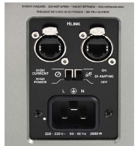
W sekcji zasilająco-sterującej znajdziemy przełączniki trybów pracy – High Current lub High Power.
