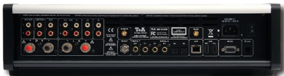
Die Rückseite des MUSIC RECEIVER zeigt die gewaltigen Möglichkeiten dieses Gerätes. Es stehen nicht nur die High-End-Analog Ein- und Ausgänge zur Verfügung, sondern auch ein jitterfreier Digitalausgang und fünf hochwertige digitale Eingänge (cinch u. optisch). Der LAN- und der W-LAN-Anschluss stellen die Verbindung zum Streaming Client her, und die USB-Eingänge sind für den Anschluss eines iPod und einer Harddisk vorgesehen. Alle Cinchbuchsen und die
