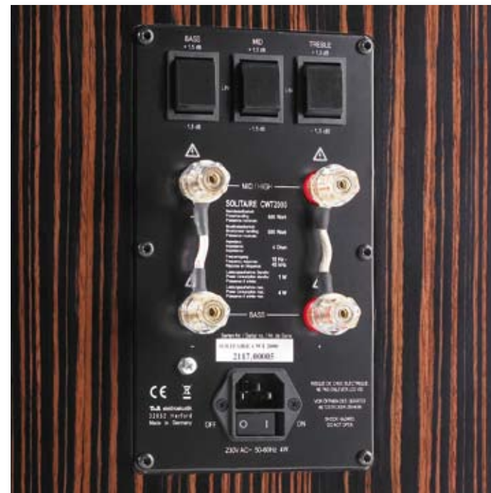
Drei Kippschalter oberhalb der Klemmen steuern den Klang.
