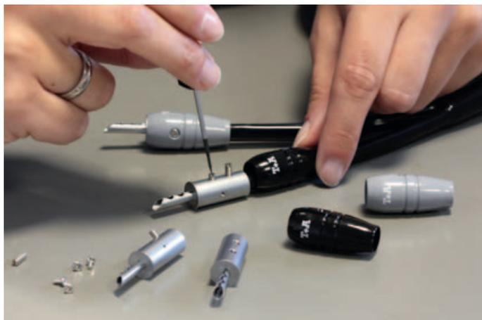
Handarbeit: Das Finish der Kabel findet am Firmenstandort Herford statt. Man versteht sich als Wertarbeiter. Die Kontakthüllen für die XLR-Kabel werden beispielsweise bei Neutrik zugekauft.
