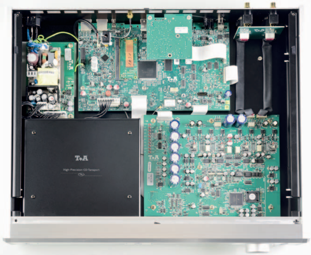
Serious Stuff: Im MP 2000 R MkII sieht es wie geleicht aus. Da freut sich das Ingenieursherz. Die große Platine hinten in der Mitte ist komplett neu entwickelt worden. Sie beheimatet neben dem Tuner die Streaming-Client-Eigenkreation.
